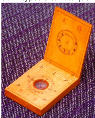
Fig. 1 : Cadran diptyque chinois de type A. Cet objet paraît être une ébauche abandonnée en cours de réalisation comme le suggèrent l'absence de graduation du cadran vertical et les lignes horaires qui convergent en plusieurs centres.
